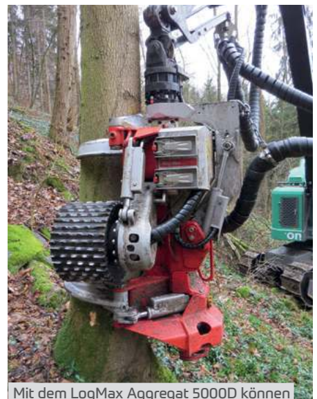
Mit dem LogMax Aggregat 5000D können Durchforstungen sowie Endnutzungen gemacht werden
